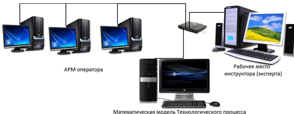
Рис. 3. Структура динамического компьютерного тренажера.
